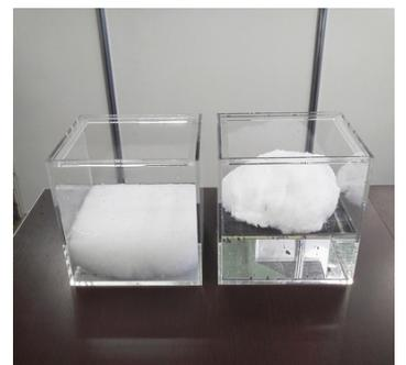
纳米纤维的亲水性、疏水性确认实验
