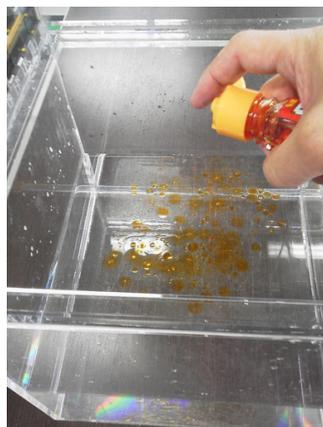
纳米纤维的吸油实验
